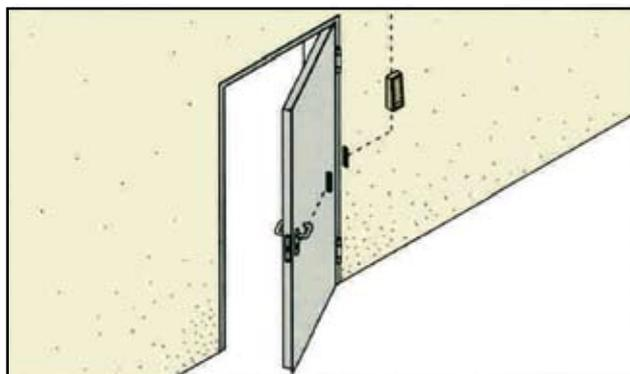
Sistema di **controllo accesso SCA** composto da: serratura (antipanico o normale) con dispositivo incorporato, contatti elettrici tra anta e telaio e cablaggio interno.
